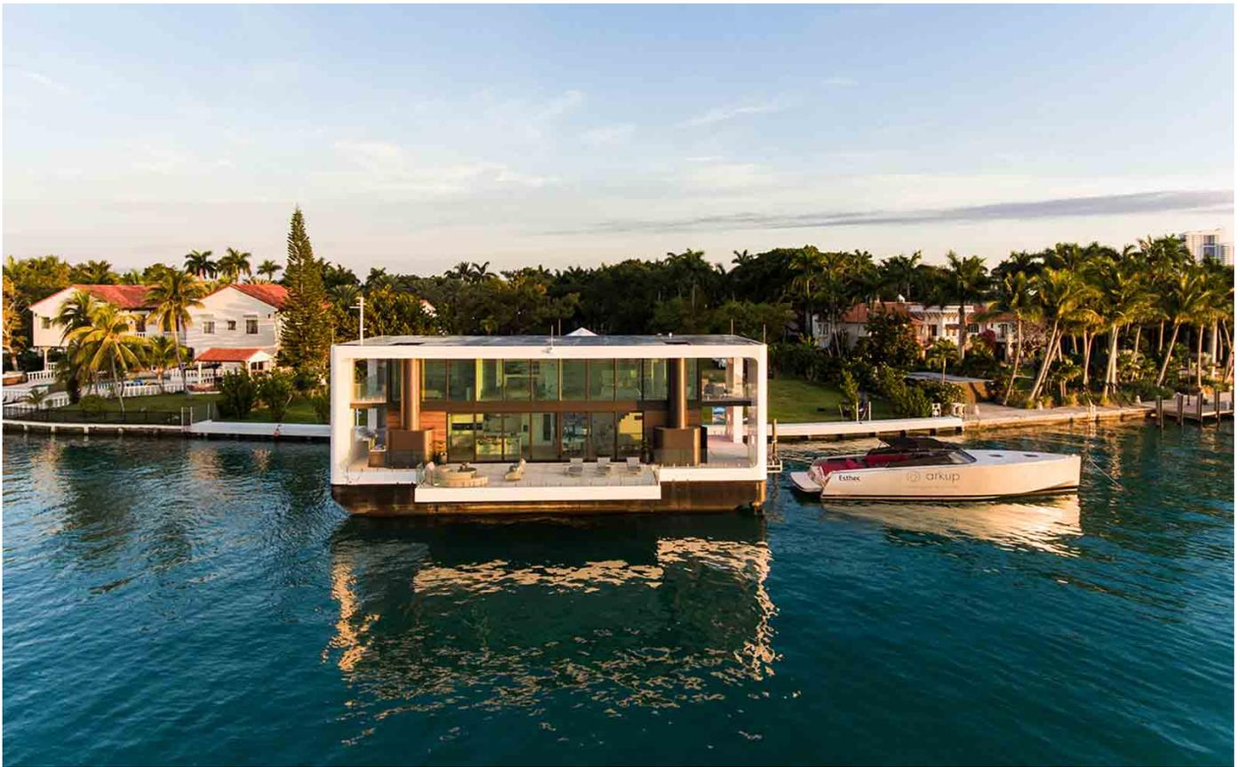
O “iate casa” também tem quatro suportes hidráulicos que podem se fixar no solo em águas rasas e erguer o iate da água. Esse é um bom recurso para não ser atacado em tempestades ou para convidados que se sentem mal com o balanço da água. Ele também é projetado para suportar ventos de 155 km/h ou um furacão de categoria 4.
