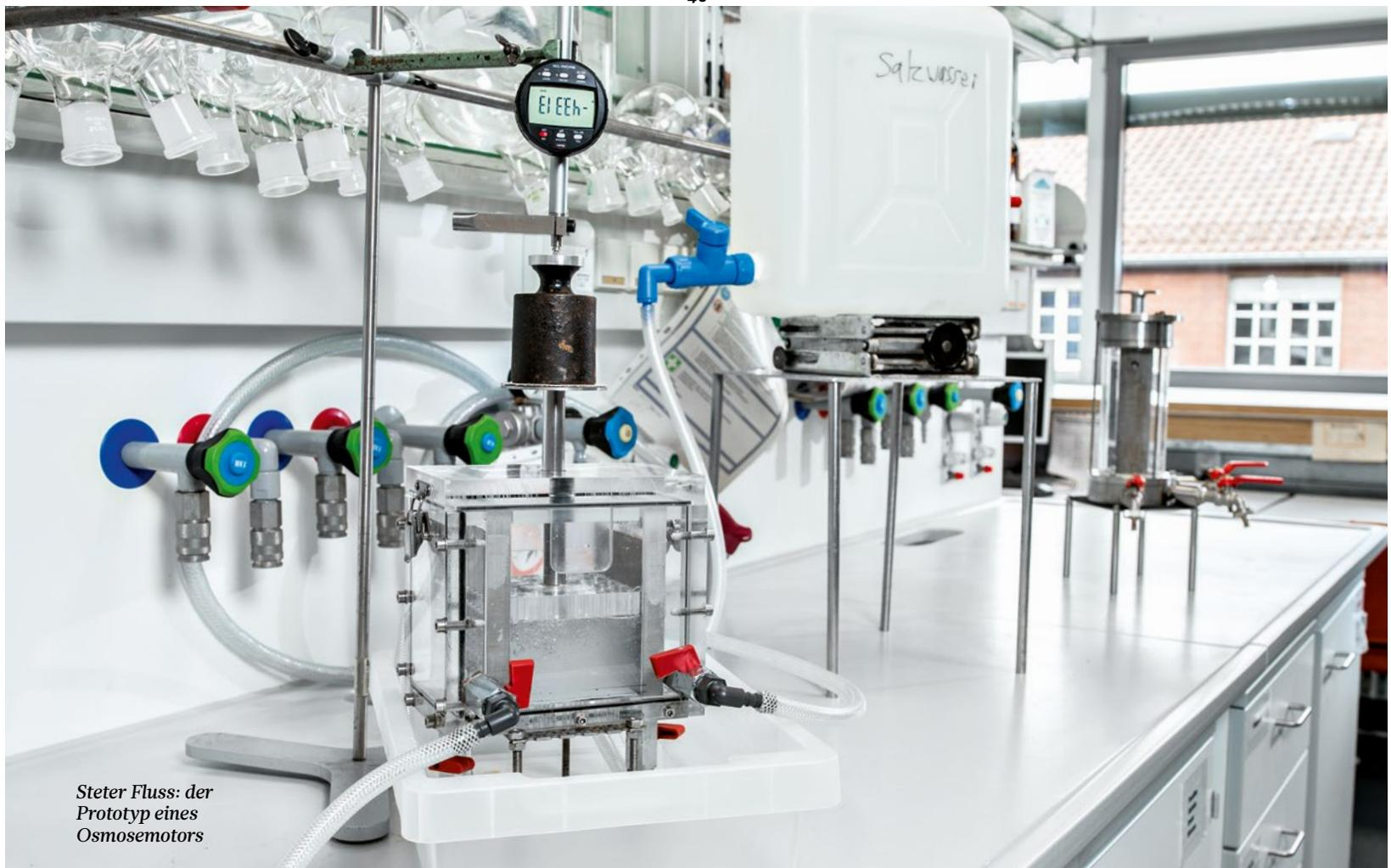
Steter Fluss: der Prototyp eines Osmosemotors
